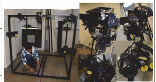
多視点カメラ計測システム Multiple view image observation system
