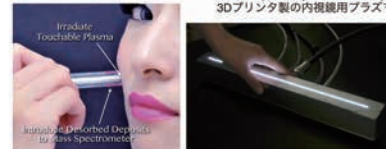
Touchable plasma 医療・分析用の触れるプラズマ 335mm linear plasma source 表面処理用リニア型プラズマ
