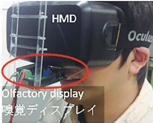
装着型嗅覚ディスプレイ Wearable olfactory display
