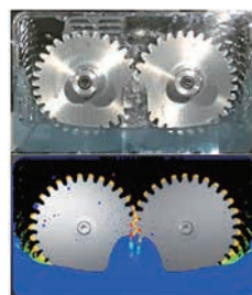
歯車装置の潤滑油挙動と動力損失 Lubricant visualization of gears
