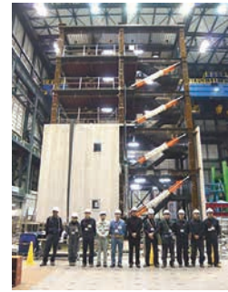
世界最大の E-Defense 震動台を用いた 実物大 5 階制振ビルの実験 (神戸地震波を入力) Full-scale Test of 5-story Building with Dampers Using World's Largest Shake-table at E-Defense
