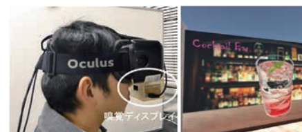
ウェアラブル嗅覚ディスプレイと香るコンテンツ Wearable olfactory display and contents with scents
