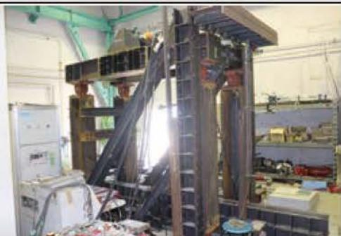
普通ボルトを用いたプレース構造の実験
