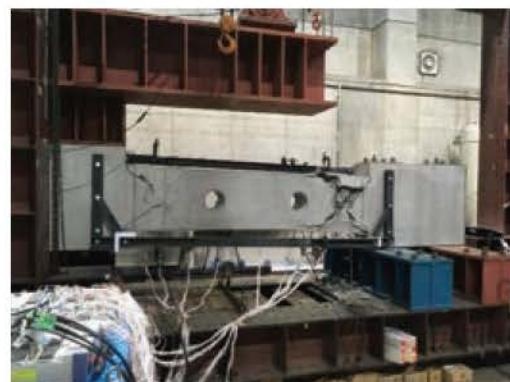
開口を有する鉄筋コンクリート梁の構造実験
