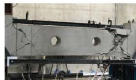
鉄筋コンクリート柱の破壊実験
