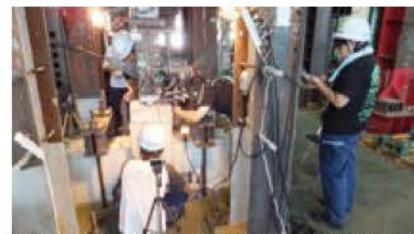
露出柱脚の基礎コンクリート周辺ひび割れに基づく損傷評価
