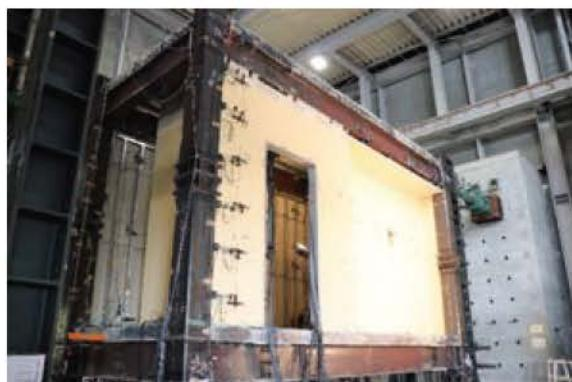
非構造部材を取り付けた鉄骨造建物の実大破壊実験
