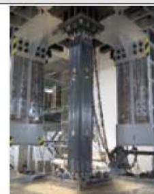
鋼柱の小振幅繰り返し載荷実験
