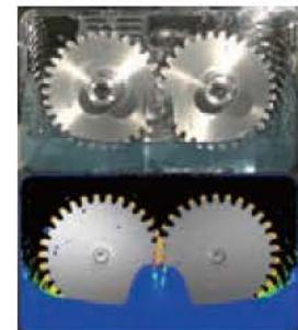
歯車装置の潤滑油挙動と動力損失
