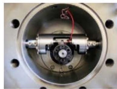
冷媒雰囲気下摩擦試験機
