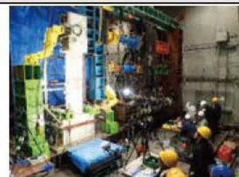
高強度せん断補強筋を用いたRC部材の載荷実験
