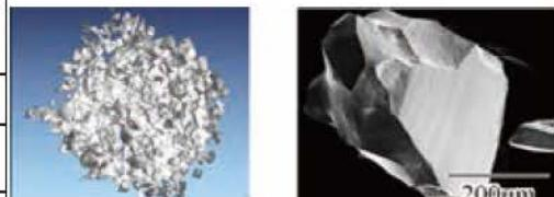
NiMnGa磁性形状記憶合金粒子分散シリコーン複合材料のマイクロCT像(左)とBi添加粉碎法により清浄な表面を持つNiMnGa粒子のSEM像
