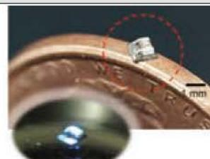
超小型生体埋め込み光刺激デバイス
