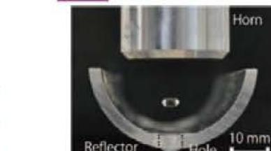
音波浮揚による非接触液体のハンドリング：超音波の放射力を用いて、薬剤などの液滴を空中で非接触で搬送・混合することを目指しています。また、空中に浮揚させたまま解析や分注を行うことも検討しています（上図）。
