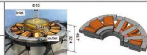
磁気浮上血液ポンプの設計と試作
