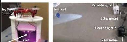
光無線給電プロトタイプ実験：(左) ドローンの浮遊中給電。
