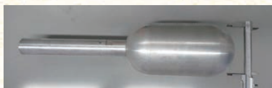
(写真3) 強力超音波用振動子の出力評価のための放射体。水に浸ける深さを変えて音響負荷を変化させる。
