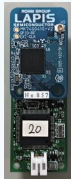
図2: 開発した牛行動推定デバイス(Sigfox対応、左)と、信州大の農場での実験の様子(右)
