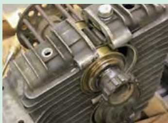
ツェッペリン飛行船のプロペラ駆動用減速機、手前がエンジン側、幅約60cm
