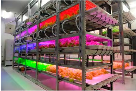
図 4.7 多段式 LED 水耕栽培システム
