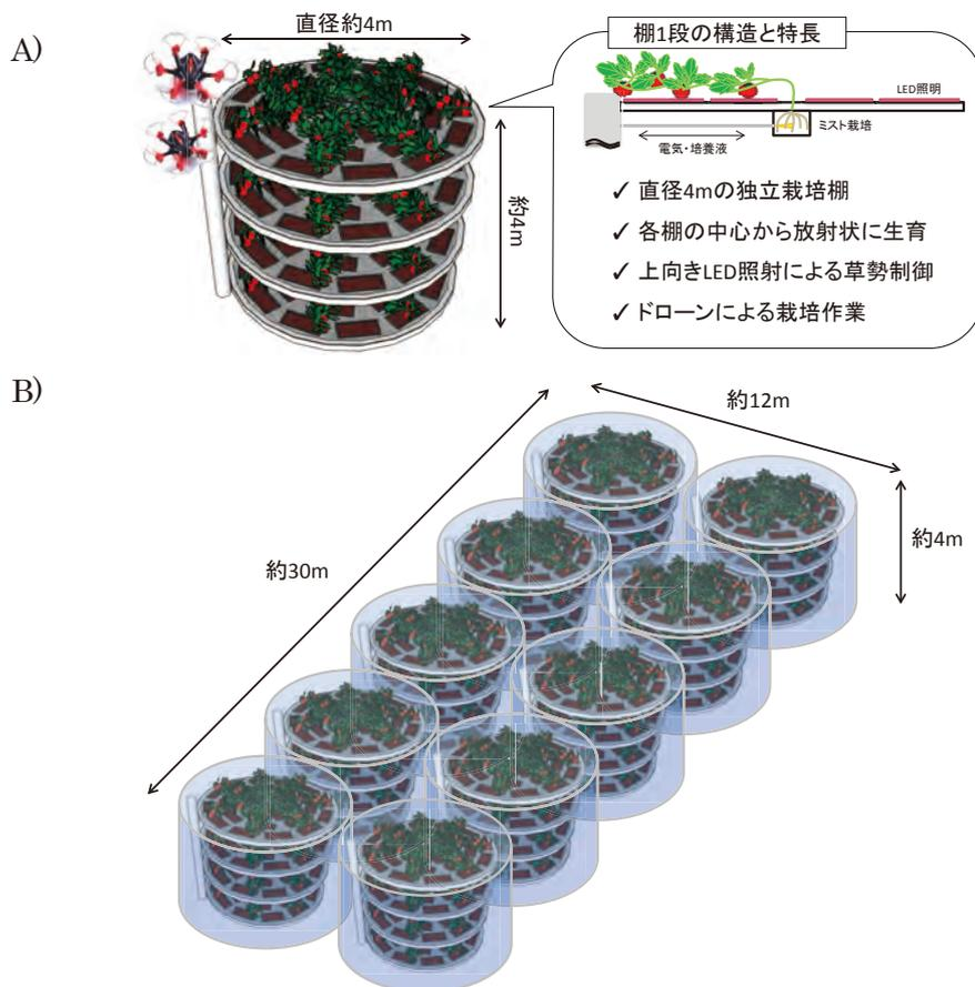
図5.7 トマト栽培のための多段棚イメージ
