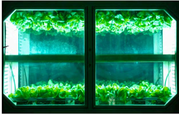
図 4.2 植物の成長に対する重力影響を地上で検証するための逆さ吊り下げ栽培
