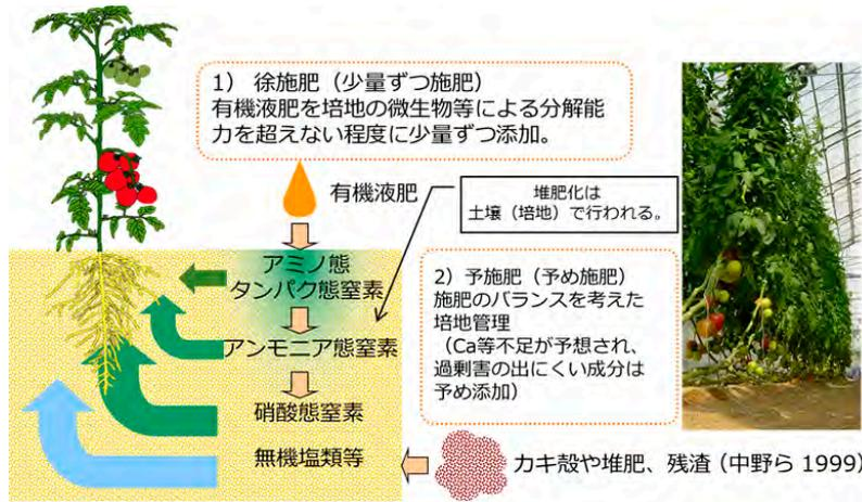
図 6.5 Fertigation のシステム
