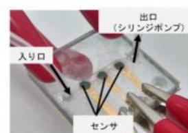
図2 イオンセンサとマイクロ流路を統合したデバイス写真
