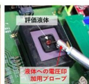
図4 センサチップの測定システム
