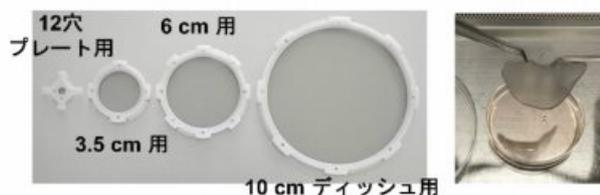
図2 細胞シート作製デバイス(試作品)
