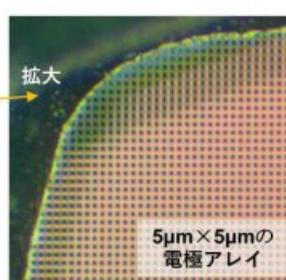
図3 センサ部分の拡大
