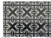
最適化により設計されたポアソン比が負の骨組構造 A frame structure with negative Poisson's ratio designed via optimization
