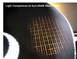
薄化されたDRAMウエハ。4ミクロン以下になると光が透過されるのがよくわかる。 Picture of thinned DRAM wafer. Light transparency increases with thinning down of Si wafer.
