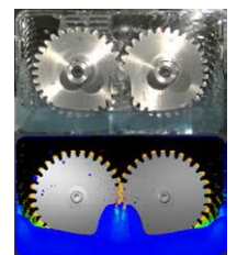
歯車装置の潤滑油挙動と動力損失 Lubricant visualization of gears
