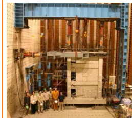
耐震壁の耐震性能を評価するための構造実験とモデル化 Structural test and numerical modeling of walls
