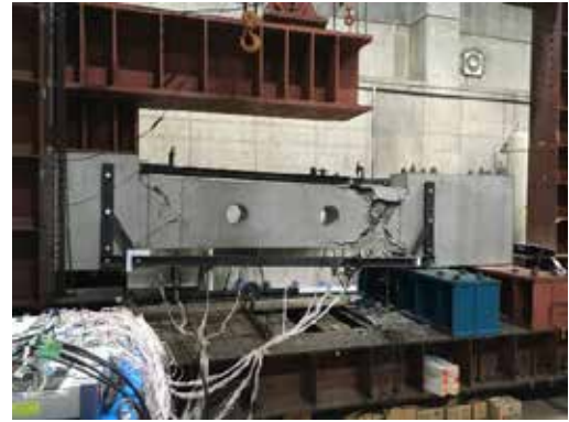
開口を有する鉄筋コンクリート梁の構造実験 Loading test on the performance of reinforced concrete beam with opening
