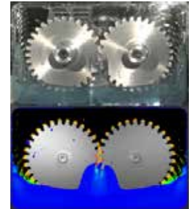
歯車装置の潤滑油挙動と動力損失 Lubricant visualization of gears
