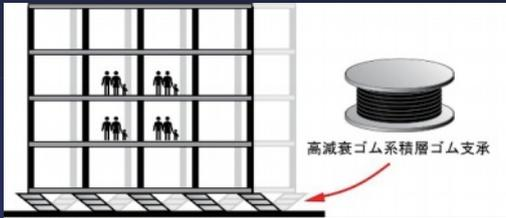
図1 免震建物の地震時の挙動イメージ
