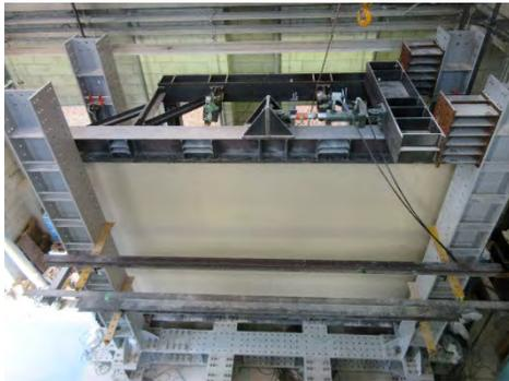
非構造壁の地震時挙動に関する実験((国研)建築研究所との共同研究により実施)
