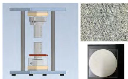
規定条件における試料の熱抵抗測定
