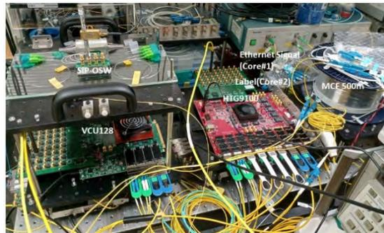
エッジ/クラウドコンピューティング基盤向け低遅延ラベル認識/光スイッチング制御部・Si 細線 on 接合スイッチの測定系
