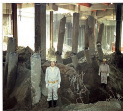
図1 液状化で破損した杭の発掘調査(1964年新潟地震後20年)
