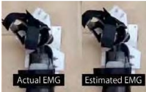
脳波から推定した筋電信号を利用した手首パワーアシストロボット A power assist robot controlled by EMG signals estimated from EEG signals
