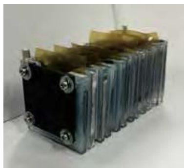
CNT を利用した微生物燃料電池 Microbial fuel cells using carbon nanotube
