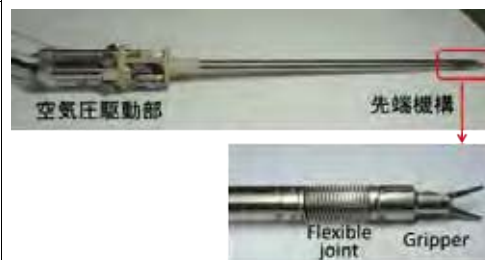
空気圧駆動による多自由度ロボット鉗子 Pneumatically-driven multi-dof robotic forceps
