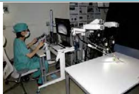
力覚提示機能を有する低侵襲手術支援ロボットシステム Master-slave surgical manipulator system with force feedback
