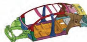
図4 異種材料接着車体
