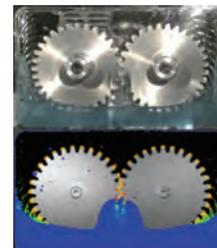
図4 歯車装置の潤滑油挙動
