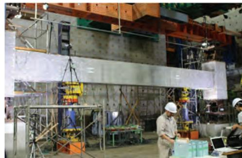
損傷制御型コンクリート構造システムの実験
