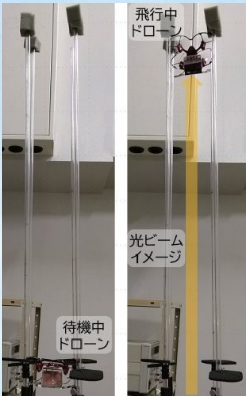
光無線給電による小型ドローンの垂直飛行動作
