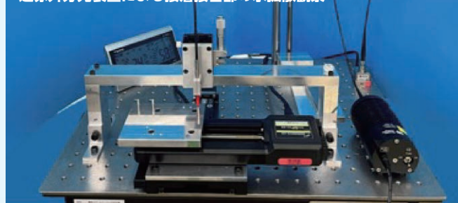
近赤外分光装置による接着接合部の水拡散観察
