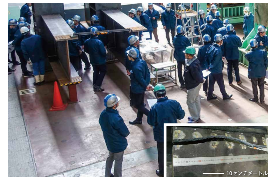
図2 SOFTechに参加する多くの企業や構造技術者が見守る中で行われた実大破壊実験。大きさを3段階に変えた相似形の鉄骨梁を用意してどのくらいの力・変形で破断するかを調べた結果、溶接の際に生じる欠陥を相似形で変化させると、鉄骨梁の変形できる量は実物大ほど小さくなり、溶接部に許容できる欠陥の大きさにはスケール効果があることがわかった。
