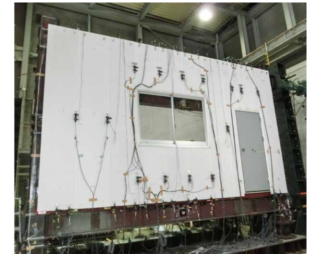
図3 実物大の壁にセンサーを取り付けた実験の様子
