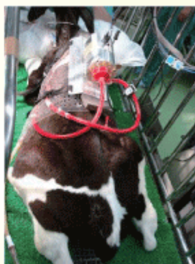
体外設置型血液ポンプとその動物実験 Disposable maglev centrifugal blood pump in animal test
