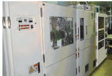
有機金属気相堆積装置 Metal Organic Chemical Vapor Deposition
