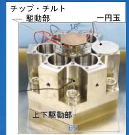
図3 製作した圧電アクチュエータ
